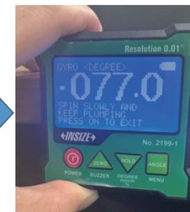
例如:測量兩個夾角為77.0“的夾角。放置在第一麪牆，按下“Angle”按鍵，旋轉至測試位置，保持旋轉角度，LCD顯示角度。
